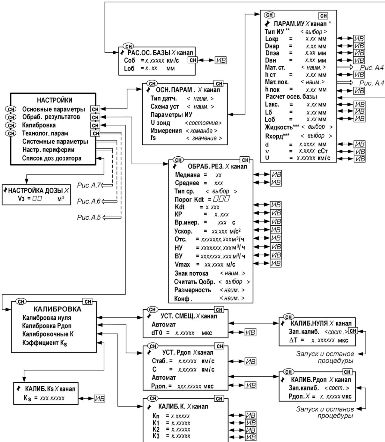
\* - набор параметров зависит от заданного типа ПЭА и схемы их установки в меню **ОСН. ПАРАМ. X канал** (см. табл.Б.3);
