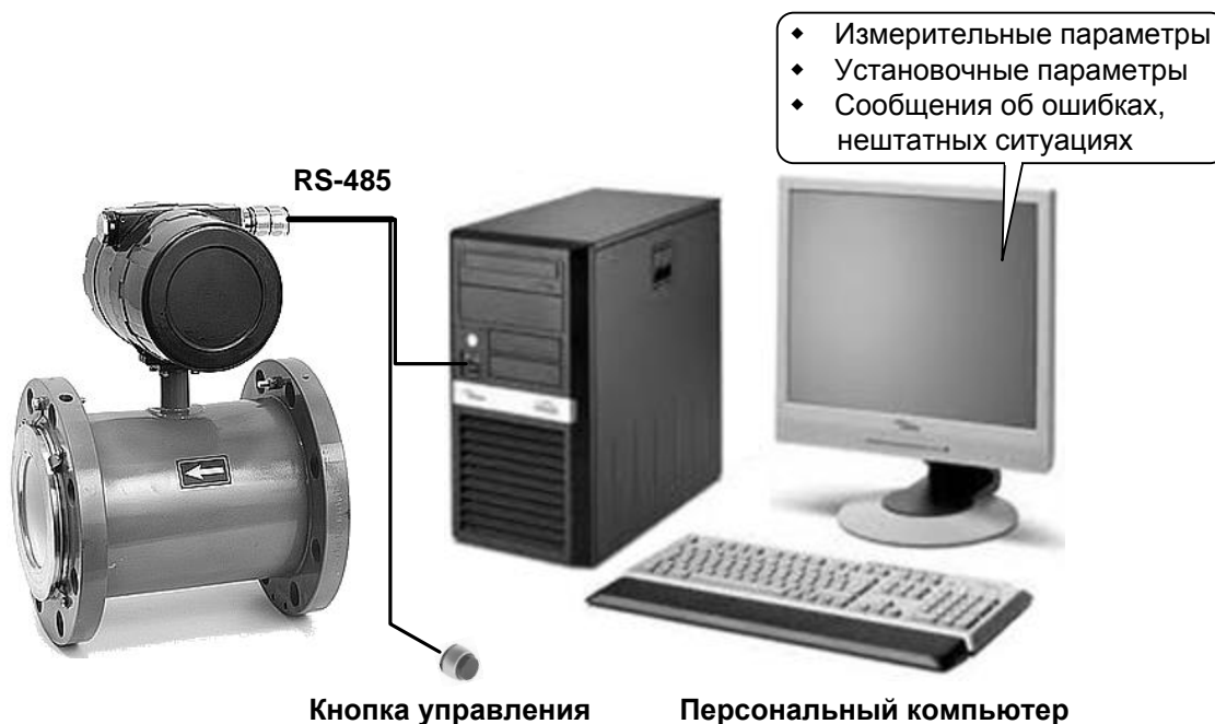
Рис.1. Средства управления расходомером ВЗЛЕТ ТЭР.
