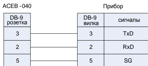
Рис.3. Подключение прибора по интерфейсу RS-232.
