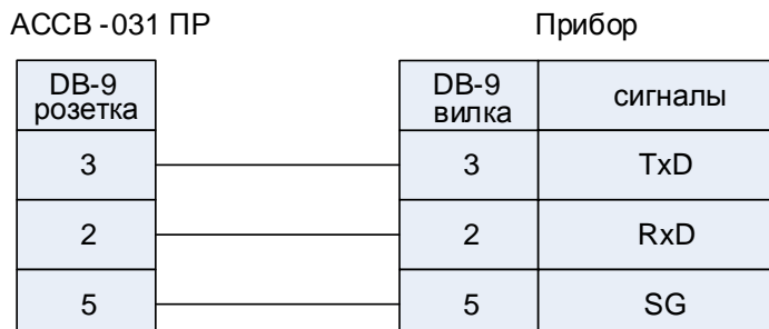
Рис.12. Подключение прибора по интерфейсу RS-232.
