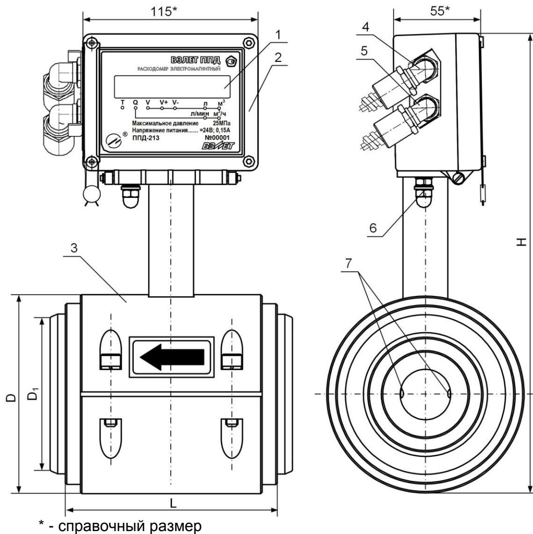
1 – индикатор; 2 – блок измерения; 3 – первичный преобразователь расхода; 4 – гермоввод кабеля связи; 5 – гермоввод кабеля питания; 6 – клемма защитного заземления; 7 – электроды.
