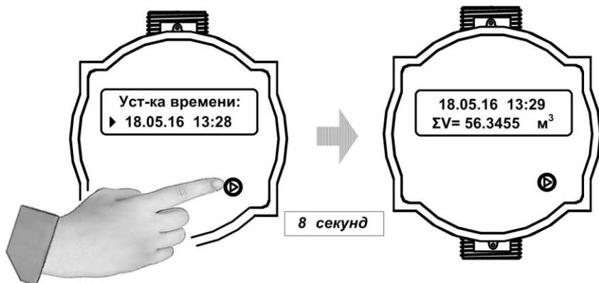
Рис.7. Перевод теплосчетчика в режим эксплуатации.
