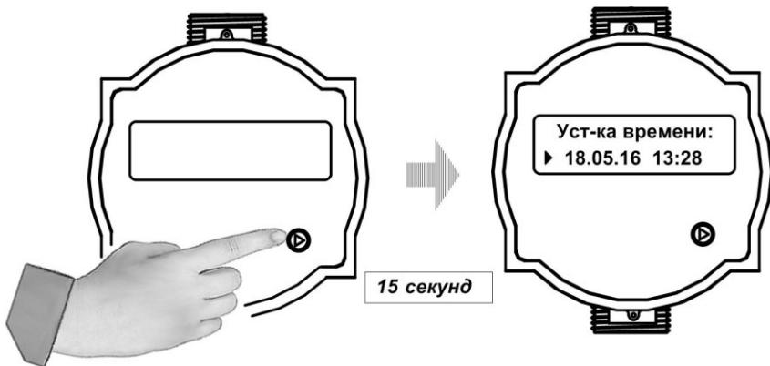
**Рис.5. Переход в режим настройки приборного времени**
