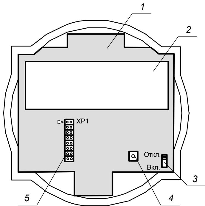
1 – плата тепловычислителя; 2 – жидкокристаллический индикатор; 3 – переключатель режимов ТВ; 4 – кнопка управления ТВ; 5 – технологический разъем.
