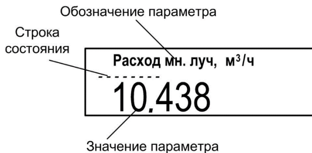
Рис.8 - Вид окна укрупненной индикации измеряемого параметра.
